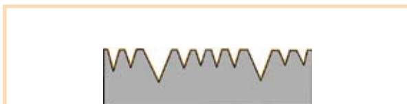
Оптимально обработанная поверхность. Бороздки структуры и микроструктуры полностью освобождены от остатков парафина с помощью металлической щетки RED CREEK Steel Ultra Fine.
