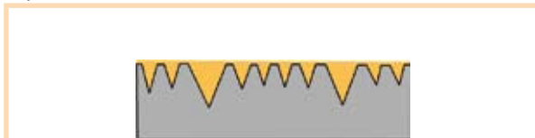
Так выглядит скользящая поверхность лыжи после снятия остатков парафина скребком. Бороздки грубой и тонкой структуры практически полностью залиты застывшим парафином.
